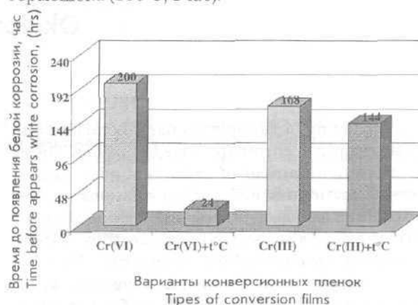
Рис. 1. Коррозионная стойкость в солевом тумане конверсионных пленок на цинке. Для шестивалентного хромирования применяли раствор типа "Ликонда-2", для хромирования - композицию "Хромит-2А" на основе трехвалентных соединений хрома
