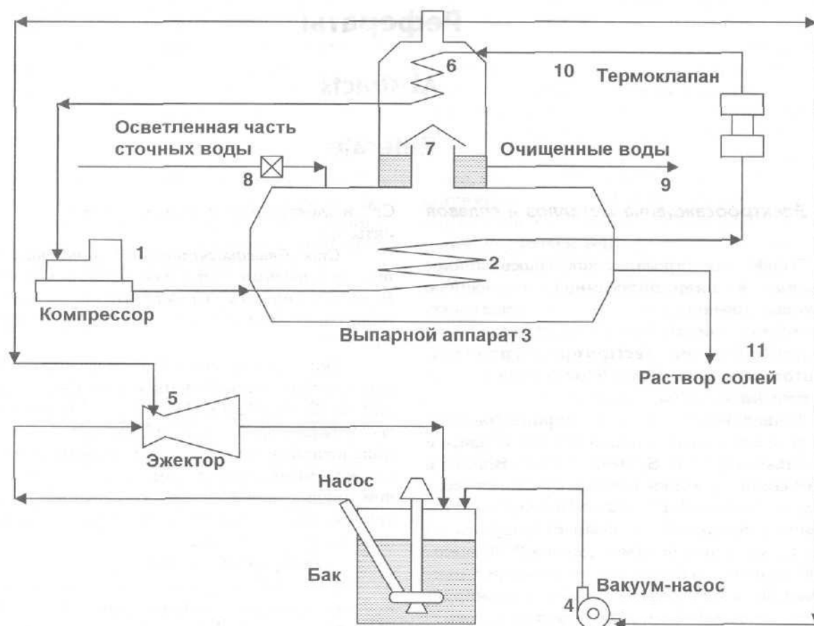
Рис.2. Схема функционирования выпарного аппарата: 1. — компрессор; 2,6. — эмеевик; 3. — выпарной аппарат; 4. — вакуум-насос; 5. — эжектор; 7. — бак; 8. — электромагнитный клапан; 9. — очищенные воды; 10. — термодатчик; 11. — раствор солей
