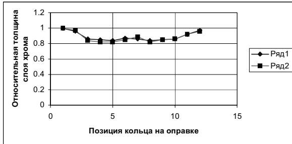
Рис. 4. Экспериментальные данные распределения хромового слоя на кольцах, одновременно хромируемых на типовых оправках: ряды чисел 1 и 2 представляют собой средние значения относительной толщины хромового слоя для каждой позиции при хромировании.
