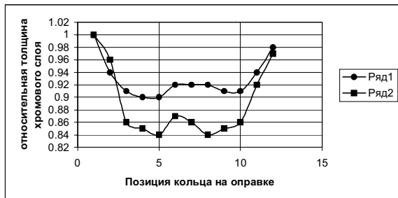
Рис. 5. Экспериментальные данные распределения хромового слоя на кольцах, одновременно хромируемых на типовых оправках: ряды чисел 1 и 2 представляют собой средние значения относительной толщины хромового слоя для каждой позиции при хромировании маслосъемных и компрессионных колец диаметром 76 мм, соответственно
