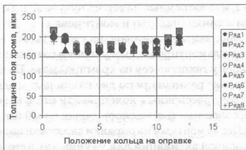
Рис. 3. Экспериментальные данные распределения хромового слоя на кольцах, одновременно хромируемых на типовых оправках. Ряды чисел 1 – 8 – значения толщины хромового слоя, соответствующие ячейкам в ванне хромирования. Пачки колец разбивали при отборе колец для измерений на 12 частей.
