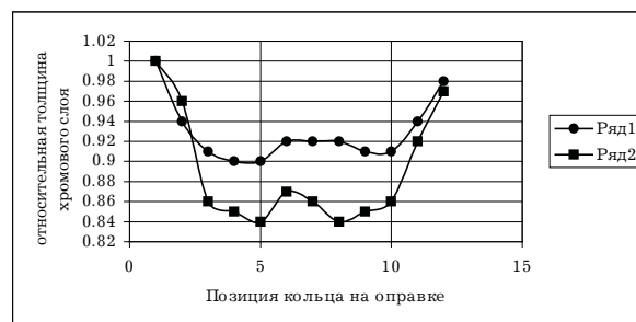
Рис.2. Экспериментальные данные распределения хромового слоя на кольцах, одновременно хромируемых на типовых оправках: ряды чисел 1 и 2 представляют собой средние значения относительной толщины хромового слоя для каждой позиции при хромировании маслосъемных и компрессионных колец диаметром 76 мм, соответственно
