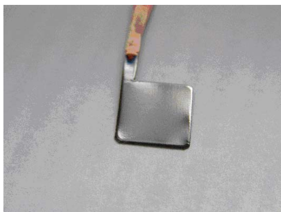
Рис. 6. Фотография осадка металлического Мо на меди, полученного из электролита без ионов никеля на основе молибденовой сини.
