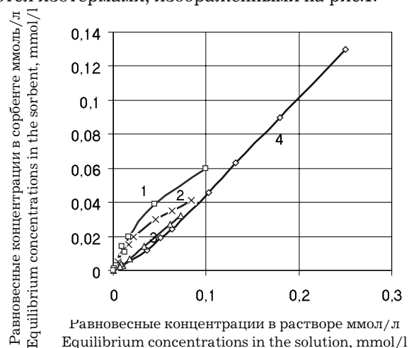
Рис.1. Изотермы сорбции ионов аммония и металлов 1. - Cu; 2. - Zn; 3.- Ni; 4.- NH 4 Fig. 1. Sorption isotherms of ammonium and metals ions
