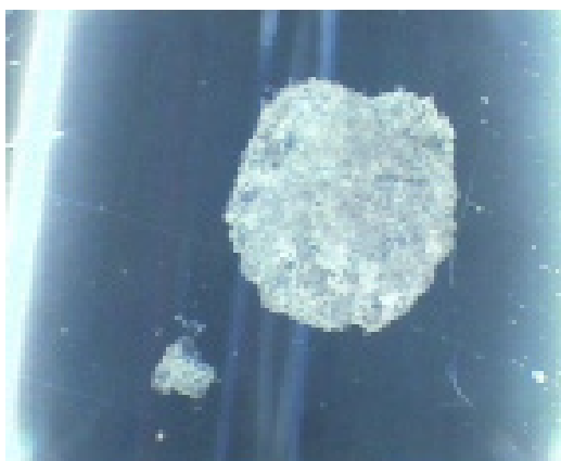
Рис.2. Коррозия на поверхности детали. Fig.2. Corrosion on the surface of part
