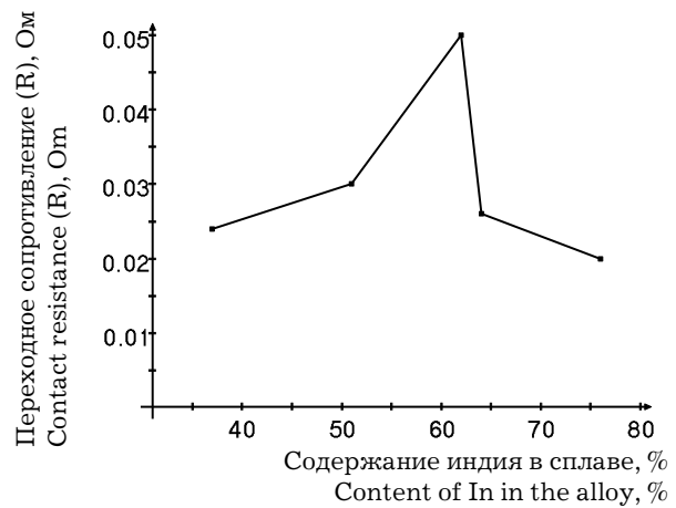
Рис. 4. Зависимость переходного сопротивления сплава индий – свинец от содержания индия в сплаве при нагрузке на контакт 1 Н и диаметре полусферы контакта 3 мм.
