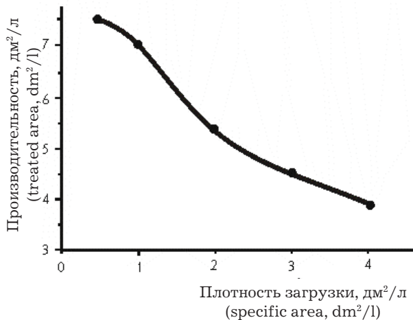
Рис.2. Зависимость межкорректировочной производительности раствора КФ-1 от плотности загрузки деталей на подвеске.
