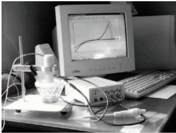
Рис.2. Аппаратно - программный комплекс «КОРИАН» на базе потенциостата IPC-Compact.
