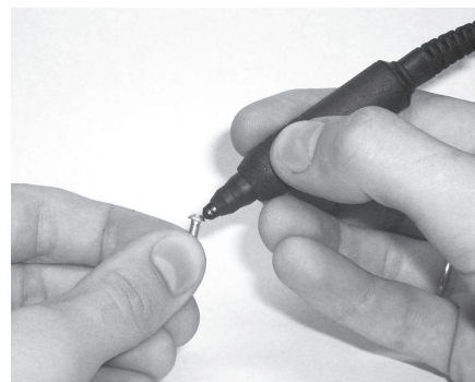
Рис. 10. Применение вихретокового фазового преобразователя для измерения толщины гальванических покрытий на крепеже.
