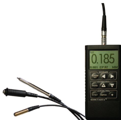
Рис. 11. Внешний вид многофункционального толщиномера гальванических покрытий всех типов Константа К6 с комплектом преобразователей. Fig. 11. Appearance of the multifunctional thickness meter of the galvanic coatings of all types "Constanta K6" with a set of transducers
