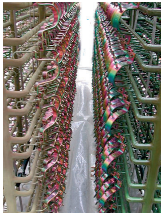
Рис. 5. Подвеска с большой пропускной способностью при осаждении из щелочного электролита
