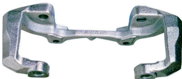
Рис.12. Литая деталь с полностью покрытой поверхностью сплавом цинк-никель в кислом электролите
