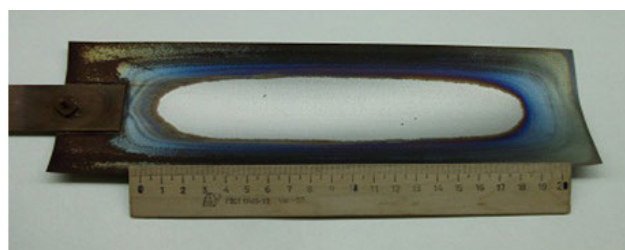
Рис.2. Внешний вид нерастворимого анода из платинированного ниобия после 8 месяцев эксплуатации в ванне улавливания после ванны цианидного кадмирования. Нерастворимый анод потерял 66,5% рабочей площади поверхности из платины
