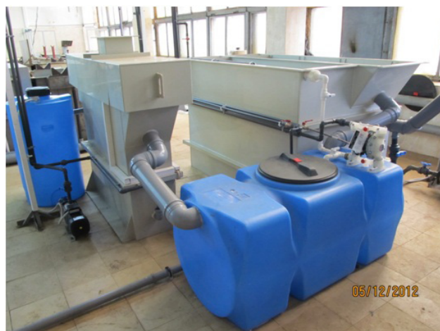
Рис. 1. Электрофлотационные модули производительностью 5 и 10 м 3 /час.
