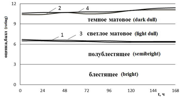
Рис. 4. Зависимость качества медных покрытий, полученных из сернокислого электролита меднения №2, от времени выдержки в нем полипропиленового волокна. Условия электролиза: t 22°C, i 2А/дм 2 , объем электролита 250 мл. 1. - масса 0,0375 г НПП без ПАОВ отечественный НПП; 2. - масса 10 г НПП без ПАОВ отечественный НПП; 3. - масса 0,0375 г НПП без ПАОВ импортный НПП; 4. - масса 10 г НПП без ПАОВ импортный НПП [4].
