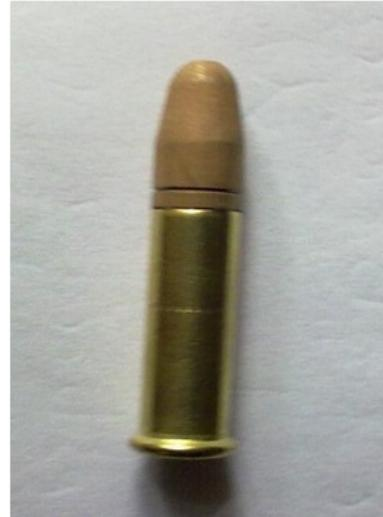
Рис. 5. Фотография патрона, снаряженного латунированной пулей
