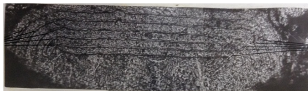
Рис. 12. Поперечный шлиф медного слоя с тонкими прослойками никеля, осажденного на дискретный катод, расположенный на неэлектропроводной плоскости в условиях равномерного микрораспределения скорости осаждения ( P = 0 ). Начальная ширина катодного участка – 100 мкм; сернокислый электролит меди без добавок. Катодная плотность тока 10 \text{ A/dm}^2
