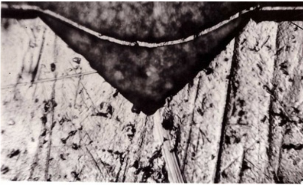
Рис. 9. Поперечный шлиф медного покрытия, осажденного из электролита с выравнивающей добавкой ( P = +0,8 ). Начальная глубина канавки 27 мкм
