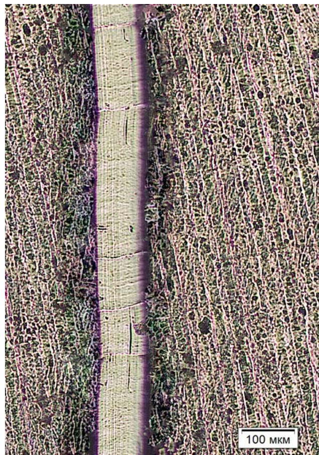
Рис. 5. Микрофотография склерометрической царапины покрытия «никель-олово»
