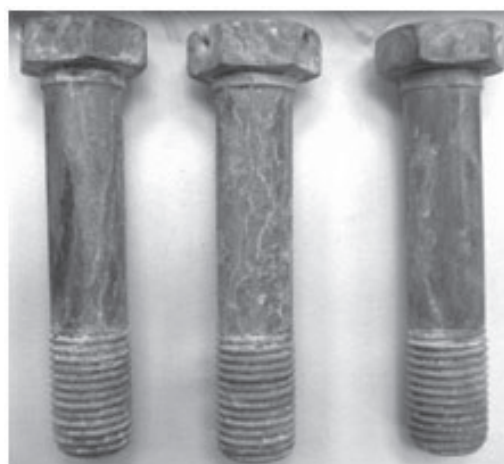
Рис. 5. Внешний стальных болтов с резьбой М12, покрытых 4-х слойным гальванотермическим покрытием с оптимальной термообработкой, после 8000 ч экспозиции в КСТ
