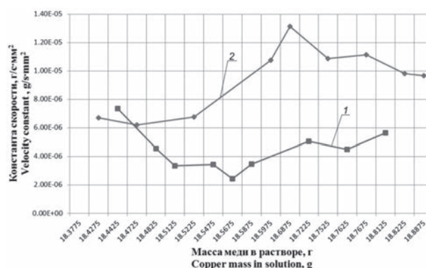
Рис. 7. Зависимость константы скорости реакции от массы меди перешедшей в раствор:
