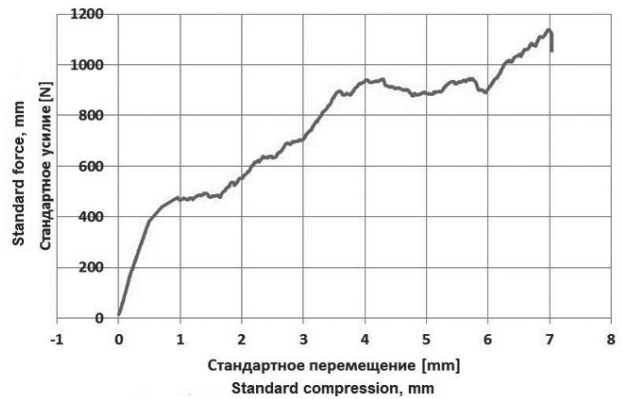
Рис. 4. Диаграмма сжатия пеноникеля Fig.4. Compression diagram of nickel foam
