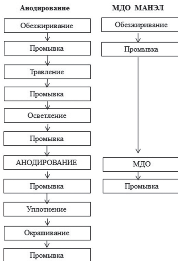
Рис. 1. Сравнительное количество операций в технологических процессах анодирования и МДО Fig.1. The comparative number of operations in the technological processes of anodizing and MAO
