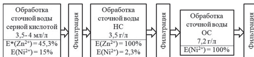
Рис. 4. Схема очистки сточной воды от цинка и никеля
