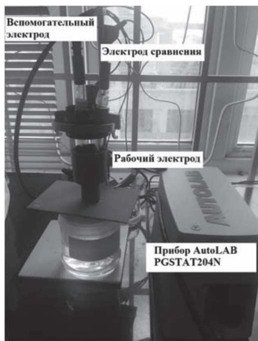
Рис. 1. Схема электрохимической ячейки Fig. 1. Diagram of an electrochemical cell
