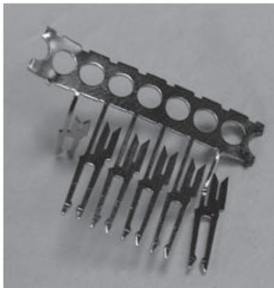
**Рис. 4.** Образец ленты, полученной в электролизёре (табл.1) при плотности тока: 6 А/дм<sup>2</sup>, температура электролита 60 °С
